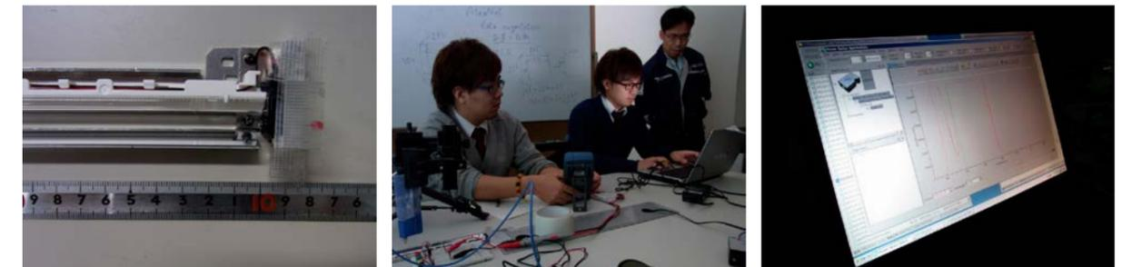
ウシオ電機より入手した、LED棒光源の色温度と波長特性を2センチ刻みで測定
