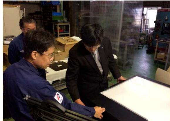
図19 透過用面発光体「エル・エコライト」の受け入れ検査
