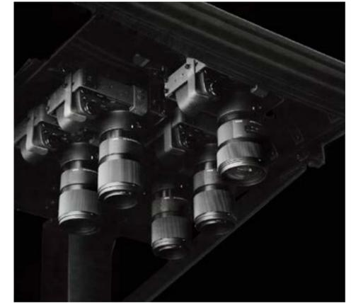
図22 マクロレンズSIGMA 70mm F2.8 DG MACRO | Artを駆使して、1億画素以上の撮像を実現する
