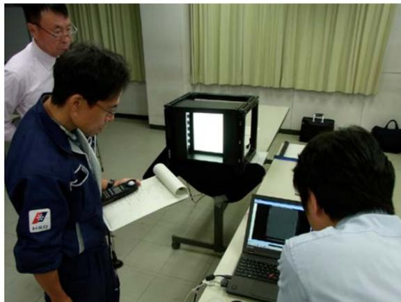
前年度に作成した光源部を再検査した。コニカミノルタ製のイメージング色彩輝度計を使い、光源部内に配置しているオパール拡散板を任意の位置に配置して、発光面全体の強度分布を測定する。35mmボジから8×10インチのボジまでムラなく撮影できる光源を設計するための検査であった
