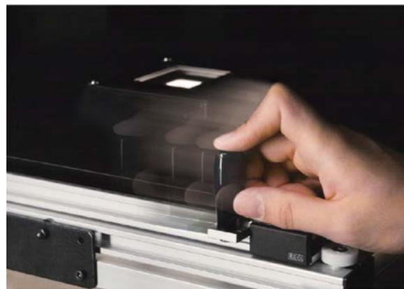
図20 XYステージにより反射原稿、透過原稿の精密画像取得を可能にしている
