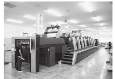
Push to Stopで運用されるスピードマスターXL106・8色両面機
