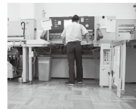
リフターを備えた断裁機で作業効率化、断裁クズはパイプで集積場に自動的に運ばれる
