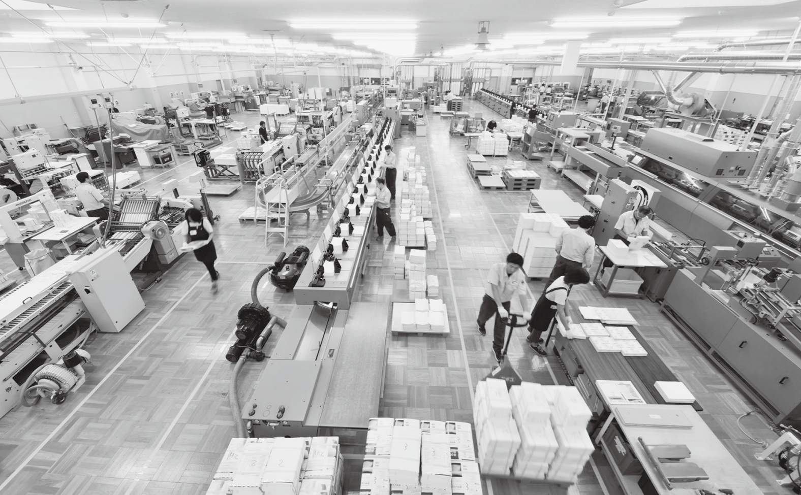
30鞍・21鞍の無線綴じ製本2ライン、6鞍・8鞍の中綴じ製本2ライン、折り機8台が稼働する製本部門
