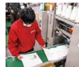
糸かがりを行う石田製本のライン
