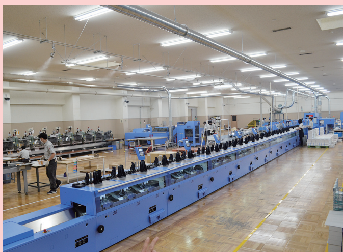
30鞍の無線綴じライン・アレグロ(左)と6鞍の中綴じライン・プリメーラMC
