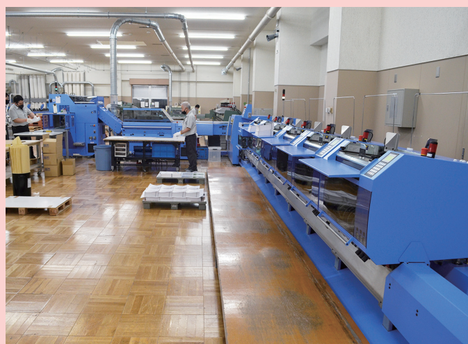
30鞍の無線綴じライン・アレグロ(左)と6鞍の中綴じライン・プリメーラMC
